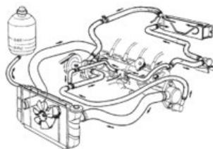
bouchon du radiateur/réservoir d'expansion. Vérifiez les tuyaux d'eau ; remplacez-les s'ils sont perforés ou endommagés. Cela évitera des problèmes à votre client. Installez toujours un nouveau thermostat et utilisez de nouvelles colliers de serrage lorsque les tuyaux d'eau sont remplacés, ce qui assurera une étanchéité correcte. N'oubliez pas de vérifier le refroidisseur EGR.
